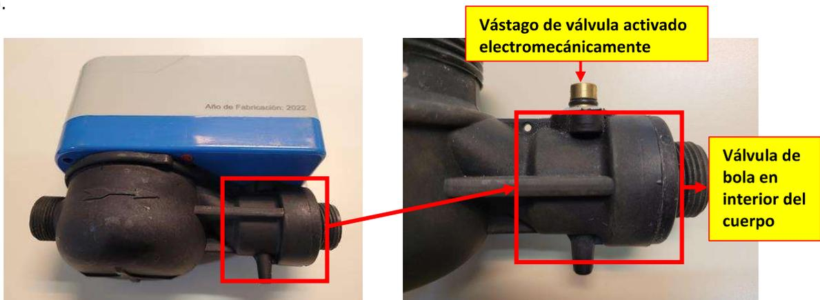
Fotos N° 4 y 5. Ubicación de válvula de bola en el cuerpo del medidor de agua LXSW-15E
