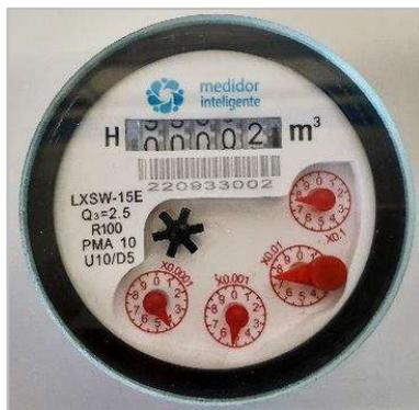
Foto N°8. Medidor antes de ensayo UV
