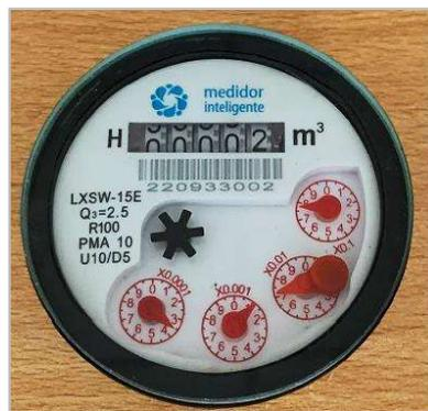
Foto N°9. Medidor después de ensayo UV
