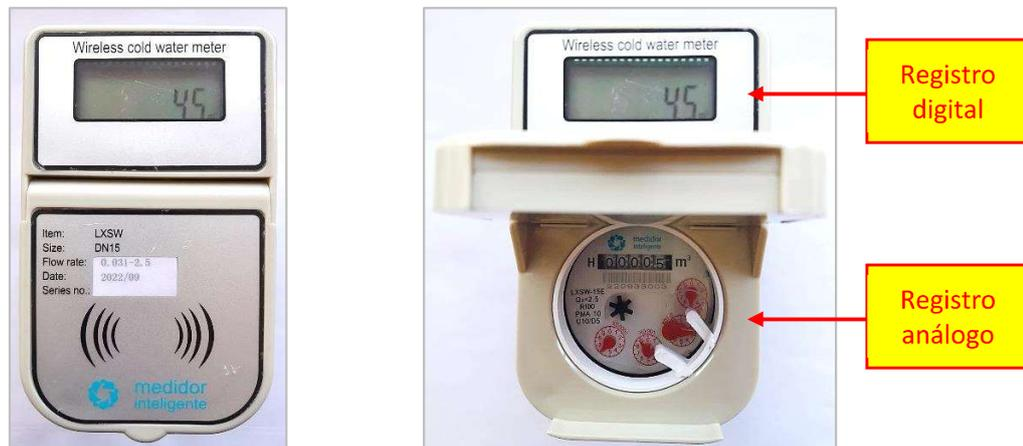
Fotos N°1 y N°2. Medidor de agua marca **Medidor Inteligente**, modelo **LXSW-15E**, Ø13mm, Q<sub>3</sub> 2,5 m<sup>3</sup>/h R100.
