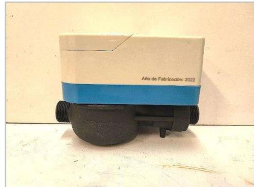
Foto N°7. Medidor después de niebla salina
